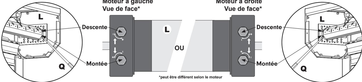
Si le sens de rotation du moteur ne correspond pas aux touches de l'interrupteur, inverser le fil noir et le fil marron du moteur, pour inverser le sens de rotation
