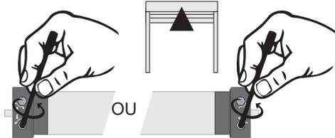
Tournez la vis de la tête moteur (sens de rotation +) correspondant à la butée haute ↓ jusqu'à la position souhaitée.
