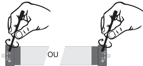
Tournez la vis de la tête moteur (sens de rotation -) correspondant à la butée basse ↑. Pour voir le résultat, appuyez sur la touche montée pour remonter le tablier, puis la touche descente. Recommencez si nécessaire.
